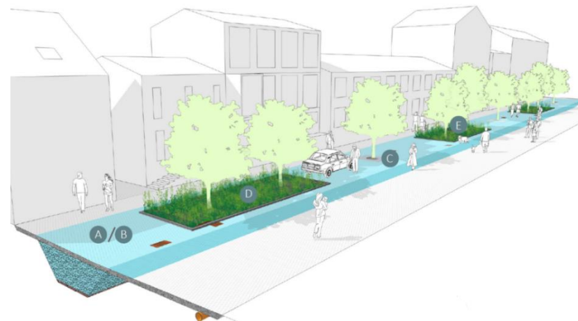
Figur 2. Exempel på hur det öppna förstärkningslagret kan tillämpas. Det blå området symboliserar ett öppet
